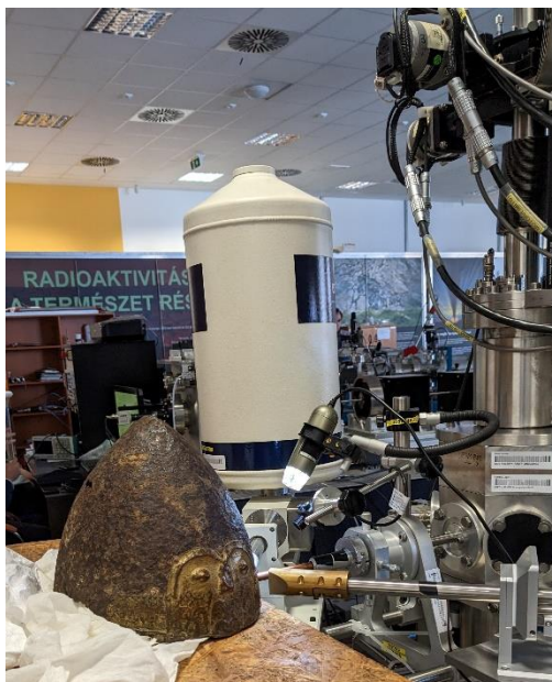
1. ábra. A Nyemija-sisak vizsgálata az ATOMKI Tandetron Laboratóriumában kihozott nyalábos mikro-PIXE módszerrel (PIXE: részecskeindukált röntgenemisszió)
