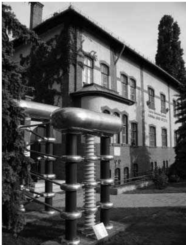
Az ATOMKI előtt kiállított 800 kilovoltes kaszkádgyorsító
