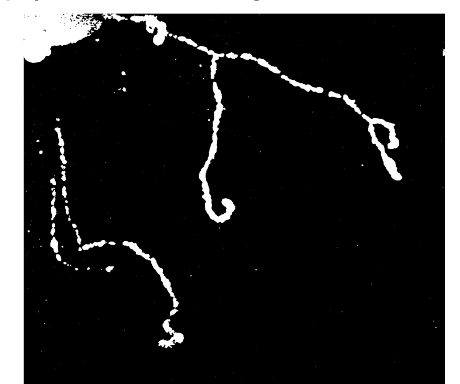
{}^{131}\text{I} bomlásából származó \beta -részecskék szóródása Scattering of \beta -particles coming from {}^{131}\text{I} decay
